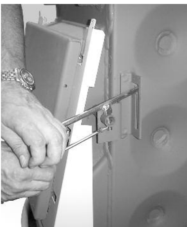
Rys. 14 Zamontować dźwignię rozpalania
