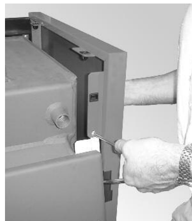
Rys. 19 Ściany boczne zamocować z przodu śrubami.
