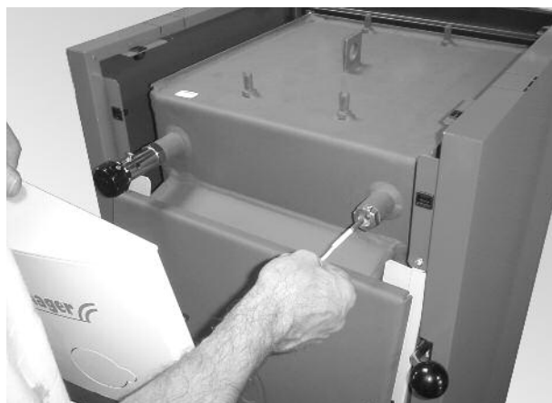
Rys. 21 Czujnik termometra umieścić w gilzie.
